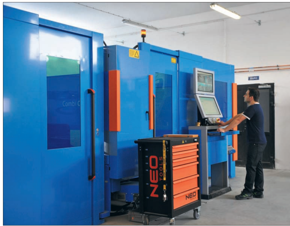
Operator obsługujący lasero-wykrawarkę, produkującą elementy kabin dźwigowych.
